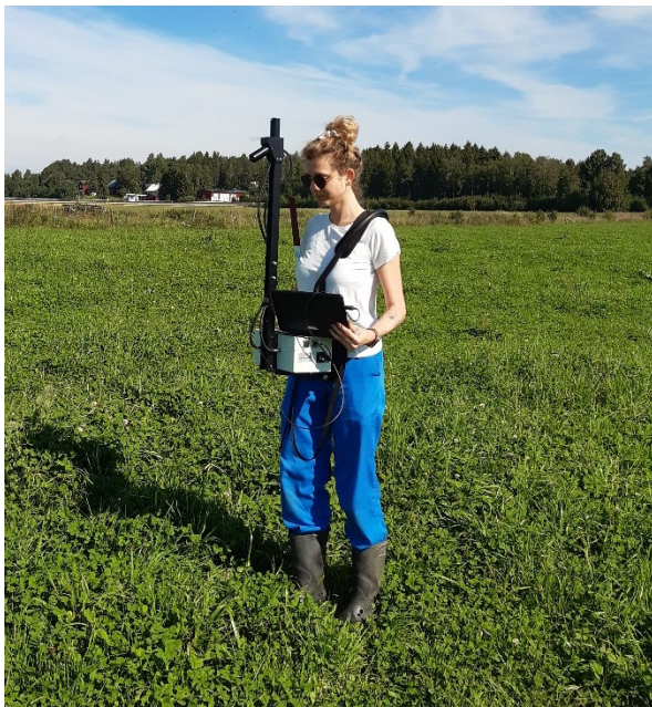
Bild 3. Manuellt buren fältspektrometer (Yara N-sensor) för mätning av kväveinnehåll mm. Den högt placerade kameran riktas snett nedåt mot mätstället.
